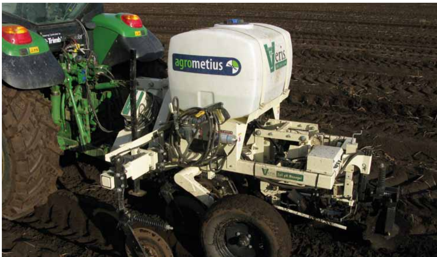
De kouters zitten in een rechte lijn achter elkaar. Een signaal beweegt via een omweg door de bodem tussen de kouters.
