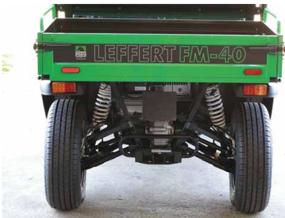
De bak heeft een netto-inhoud van 0,25 kuub en een 80 cm hoge laadvloer.
