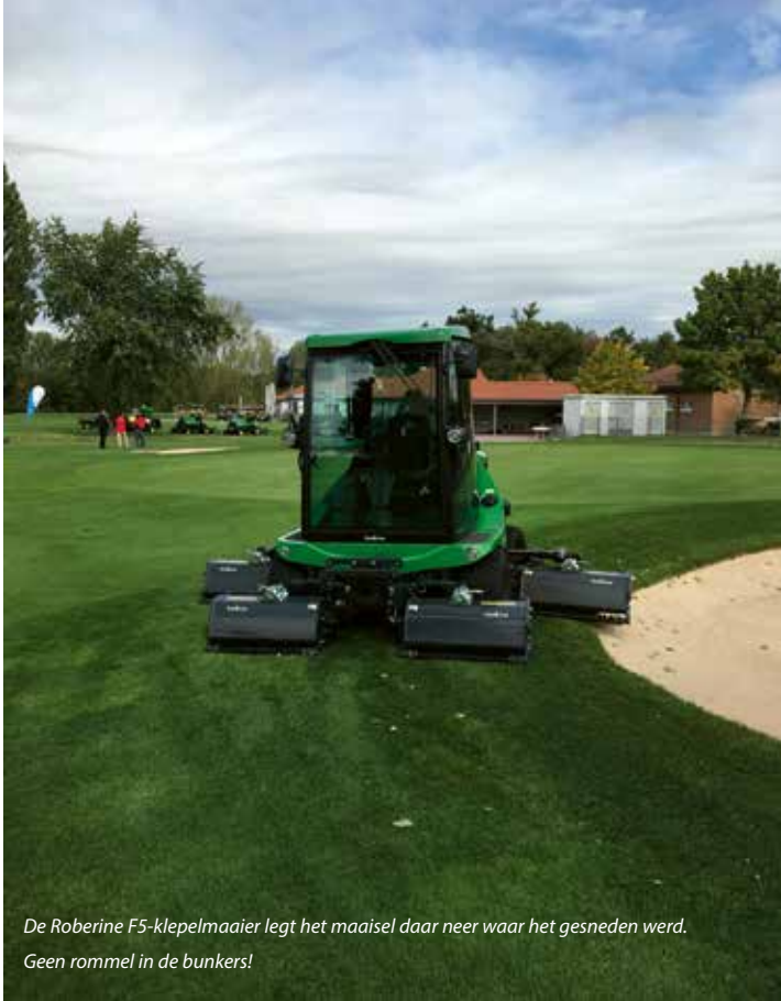
In dezelfde werkgang kun je dankzij het floating head-systeem met deze klepelmaaier zelfs een talud meemaaien.
