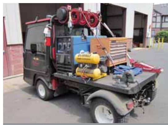
Foto 4: De zelf ontworpen mobiele werkplaats.
