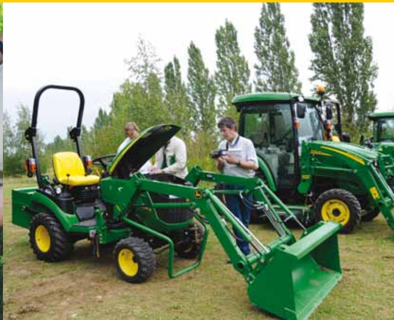
Mini compact 1026 R met makkelijk te koppelen en ontkoppelen frontloader.
