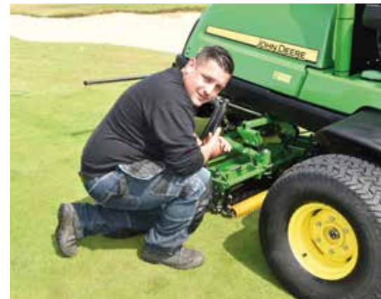
Monteur Edwin vindt het waardevol dat de vijf maaikooien van de Precision Cut 8700A kantelbaar zijn voor onderhoud.
