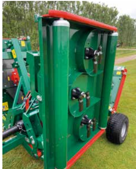
De Wessex CRX-320 is een driedelige maaier, specifiek ontworpen voor het maaien van sterk geonduleerde roughs op golfbanen.
