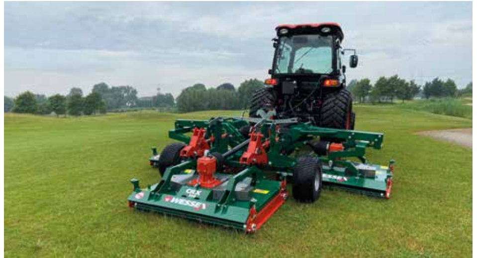
De Wessex CRX-320 is een driedelige maaier, specifiek ontworpen voor het maaien van sterk geonduleerde roughs op golfbanen.
