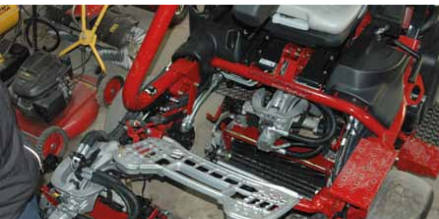
De treeplank vergrendelt zich na sluiten vanzelf.
