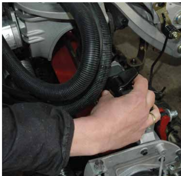
Kooi vergrendelen aan de machine, zonder gereedschap!
