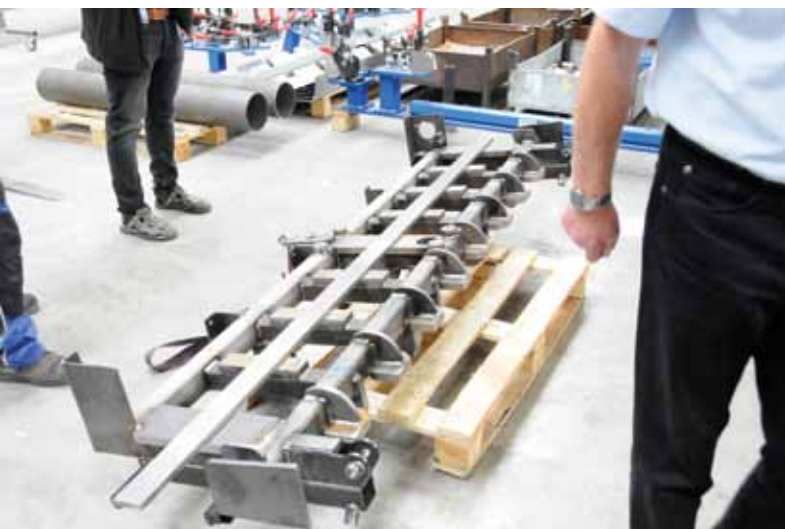
Het chassis van een beluchtingsmachine. Door het gebruik van lasrobots en een richtbank is dit altijd 100 procent vlak.
