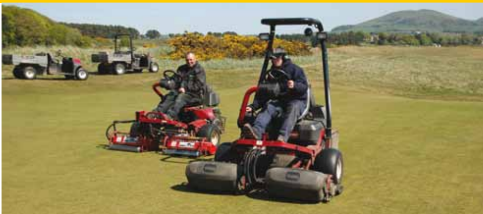
Direct na de metingen op Leven Golf Links werden de greens gemaaid en tegelijkertijd met een vibrerende rol bewerkt. De metingen met de stimp-, de clag- en de truenessmeter werden daarna herhaald en vastgelegd.
