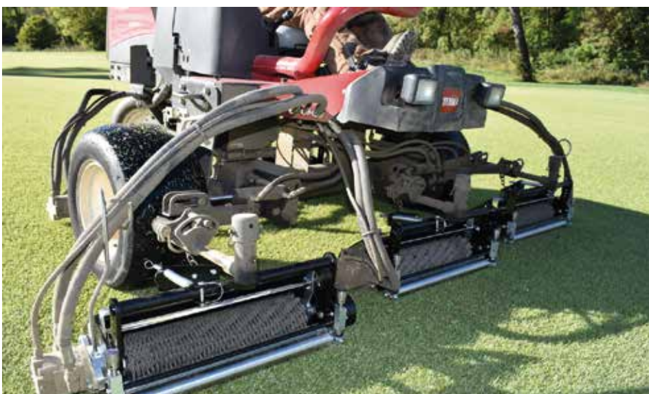
Fairway Collection System op een Toro-fairwaymaaier; hier is goed te zien dat het frame op een fairwaymaaier past.
