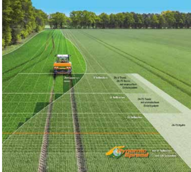
Amazone maakt het nu dankzij section control-software en gps mogelijk maximaal 64 tot 128 strooisecties in te schakelen.
