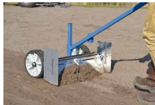
De kleine Strakvlak, voor de eerste bewerking heeft een maximale werkbreedte van 117 cm.
