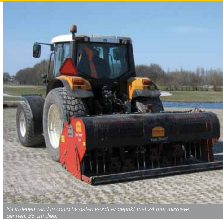
Kort maaien, 2 cm zand erop en daarna prikken met massieve conische pennen tot een diepte van 15 cm.
