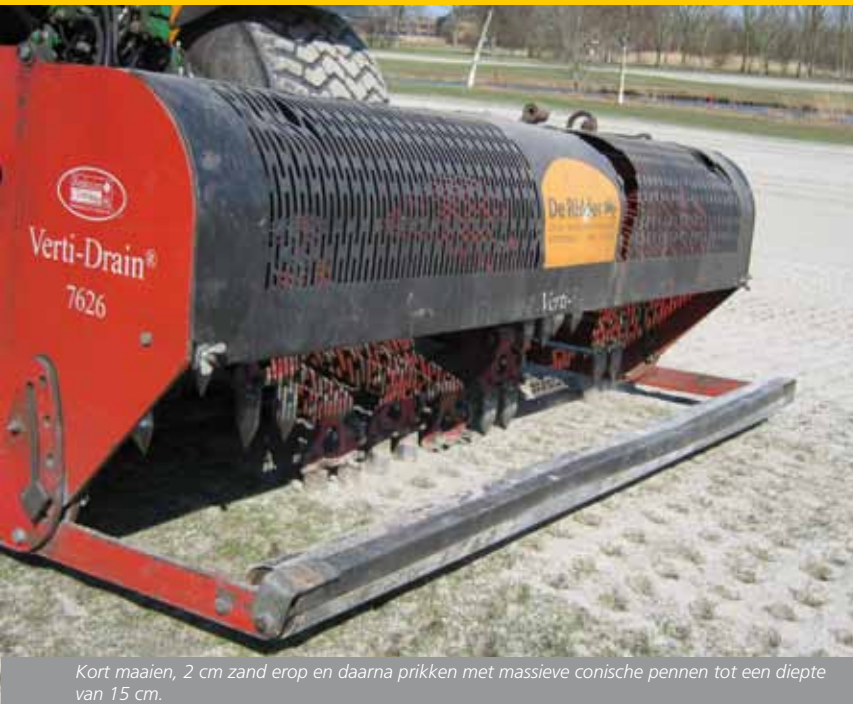
Na inslepen zand in conische gaten wordt er geprikt met 24 mm massieve pennen, 35 cm diep.
