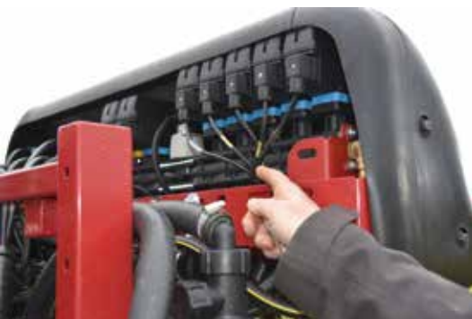
Kranen en de computer voor de aansturing zijn opgebouwd op de machine.
