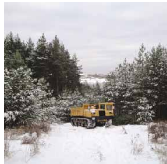
Een 'Morooka' wordt gebruikt voor het transport van grond onder zware omstandigheden en bij steile hellingen.
